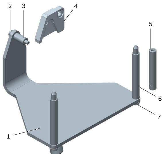
Fig. 1: Supporto motore T10359A
